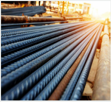
حديد تسليح Reinforcement steel
